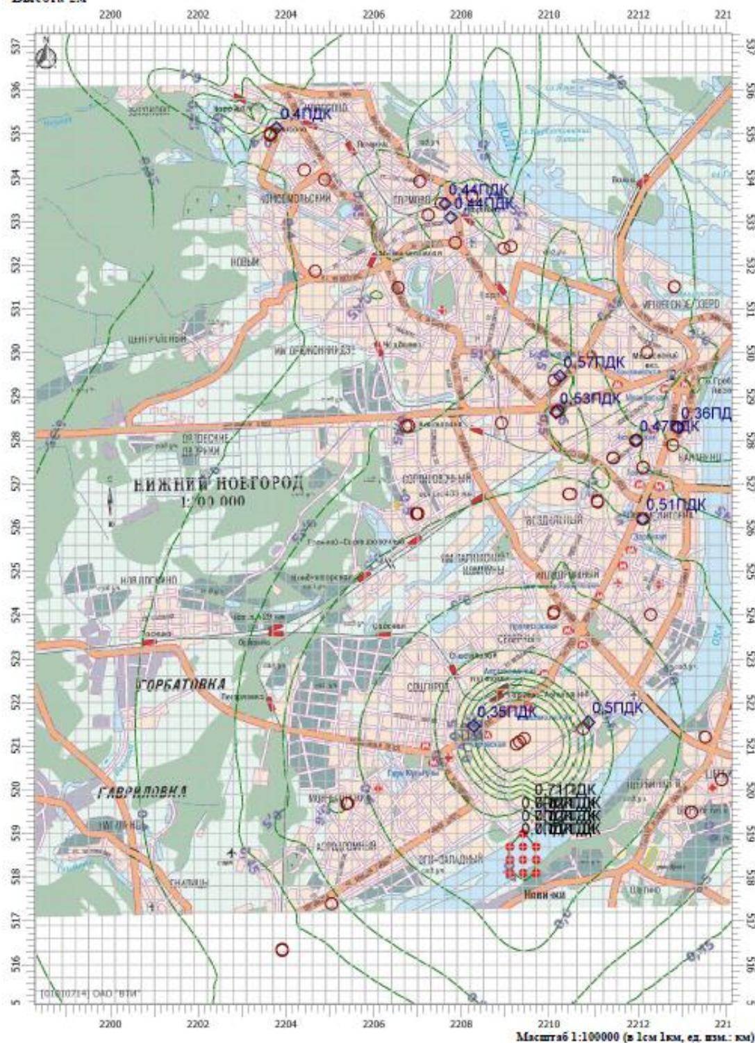
Рисунок 2.7.2.1 – Значения максимальных приземных концентраций от суммации выбросов диоксида азота и диоксида серы на существующее положение - максимум и на постах наблюдения (западная часть города) (зимний период с учетом фона)
