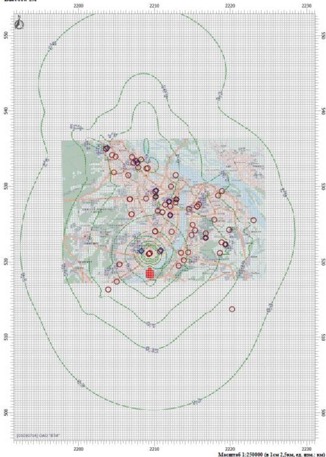
Рисунок 3.6.1 – Поля максимальных приземных концентраций от суммации выбросов диоксида азота и диоксида серы на перспективу – максимум и на постах наблюдений (зимний период с учетом фона)
